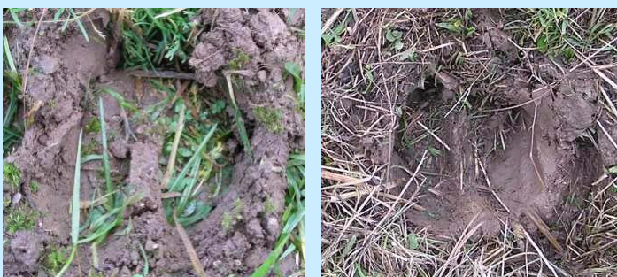
Abb. 7 u. 8: Zum Vergleich die Abdrücke der mechanischen (links) und einer echten Rinderklaue – auch augenscheinlich ein realistisches Ergebnis
